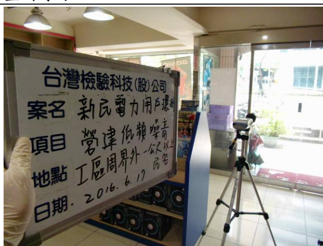
監測項目：低頻噪音 監測地點：工區周界外一公尺以上民宅 監測時間：2016.06.17
