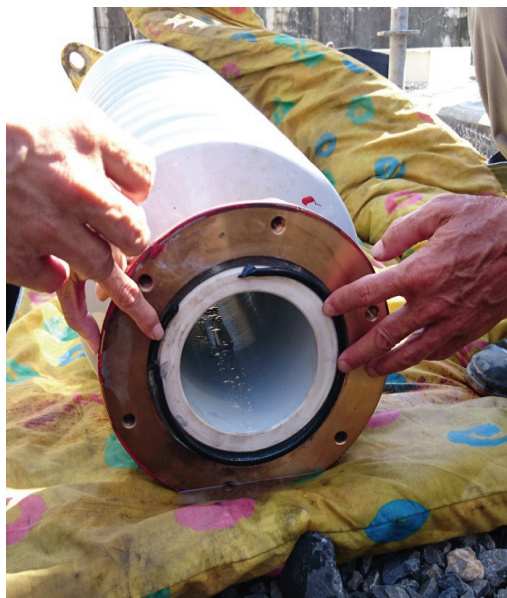
圖 12 上部金屬法蘭部 O-Ring 斷裂
