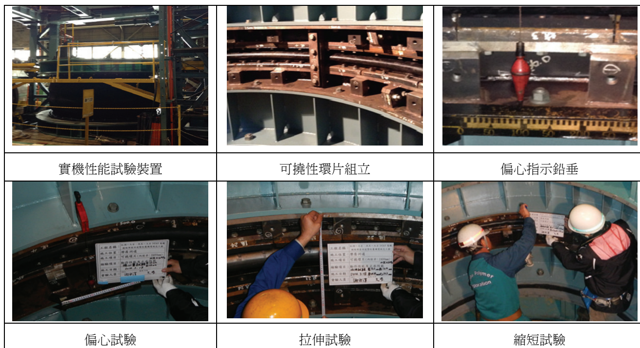
圖 16 大安案可撓性環片實機試驗
