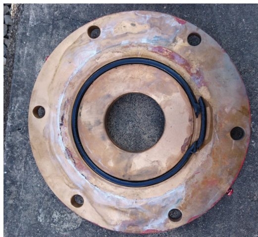
圖 14 上部金屬 O-Ring 斷裂模擬狀況
