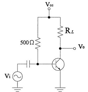
[C] 20. 如右圖所示之電路，若電晶體的  $\beta$  值為 100，則使電晶體處於飽和狀態的最小  $I_B$  約為多少？
