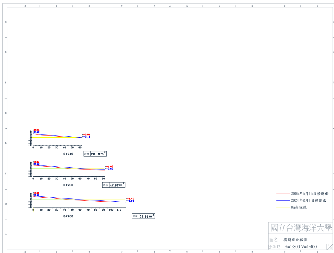
圖 4-5(a) 2024 年 8 月 1 日 B 監測區橫斷面比較圖
