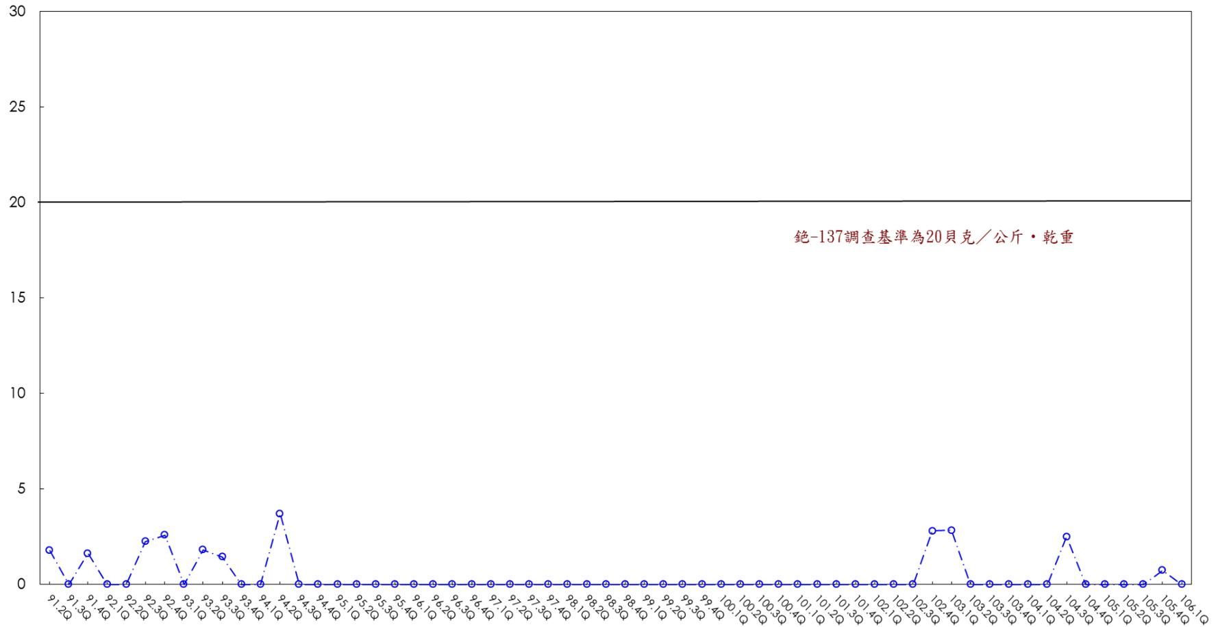
圖4 蘭嶼貯存場排水口岸砂(SS502)加馬能譜分析結果
