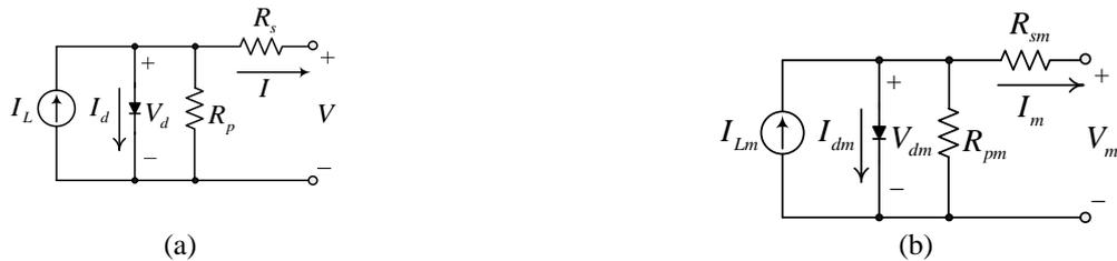
圖 2 (a)太陽能電池等效電路；(b) PV 模組等效電路
