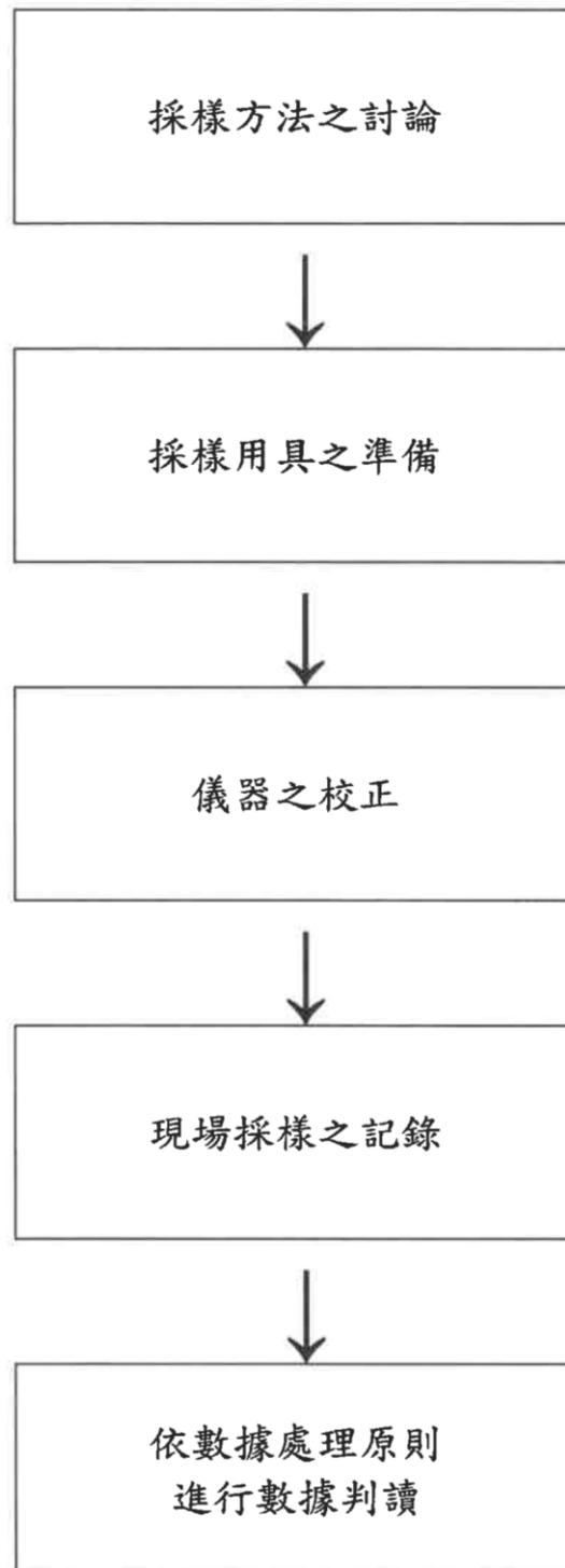
圖 1.5-1 品保品管作業流程圖
