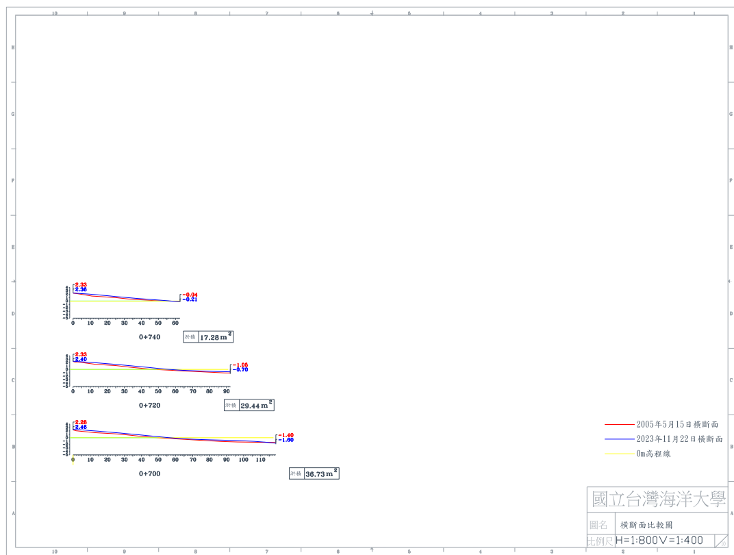
圖 4-5(a) 2023 年 11 月 22 日 B 監測區橫斷面比較圖
