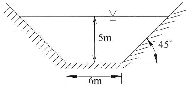
[Manning equation:  $Q = \frac{1}{n} A R_h^{2/3} S_0^{1/2}$  ( $\text{m}^3/\text{s}$ ), 其中  $n = 0.02$ ,  $A$  為流動面積,  $R_h$  為水力半徑,  $P$  為潤濕周長,  $S_0$  為渠底坡度]
