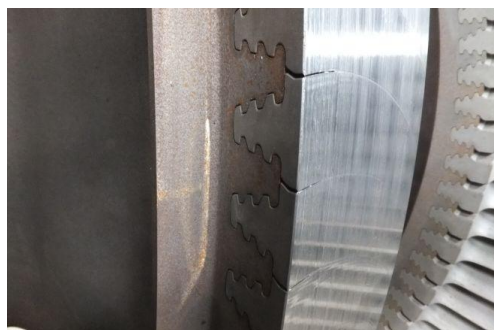
圖 2 切除葉片保護葉根槽
