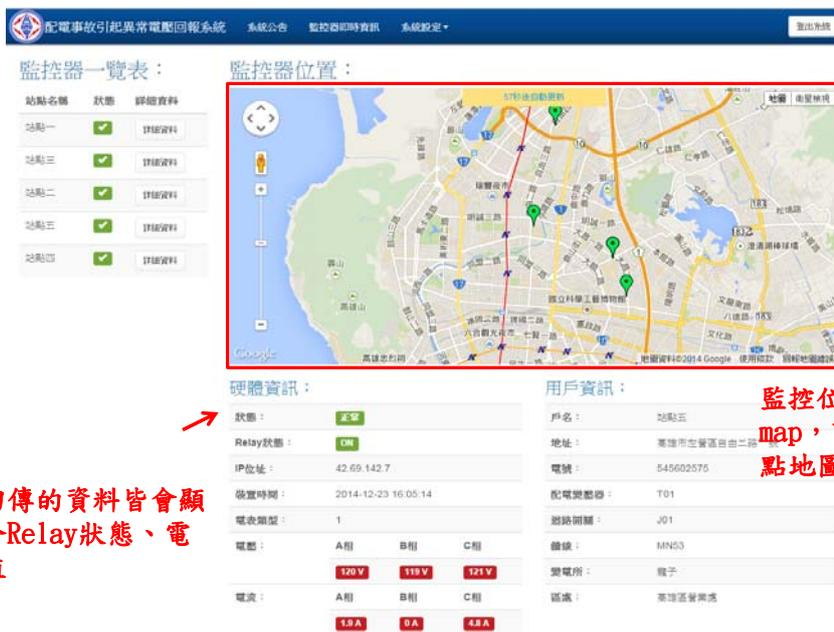
監控器所回傳的資料皆會顯示於此包含Relay狀態、電壓、電流值
