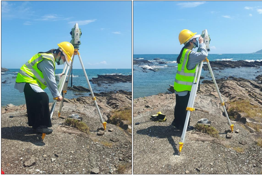
圖 3-2 全站式經緯儀架設於控制點
