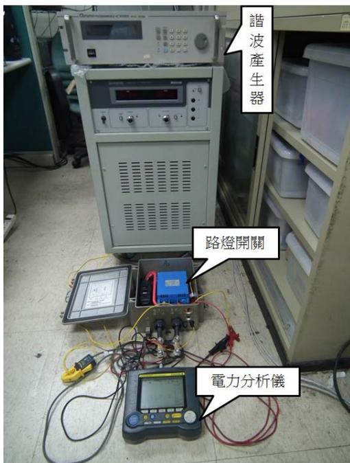
圖 14 諧波試驗接線圖
