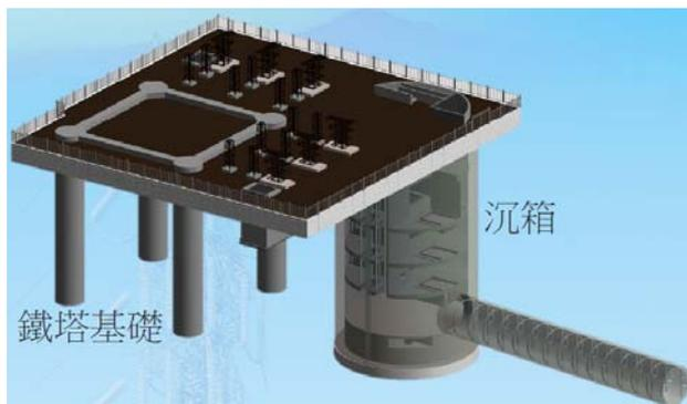
圖 6 鐵塔基礎、沉箱及洞道模型<sup>[15]</sup>
