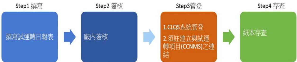
圖 9 CLQS 系統管登流程
