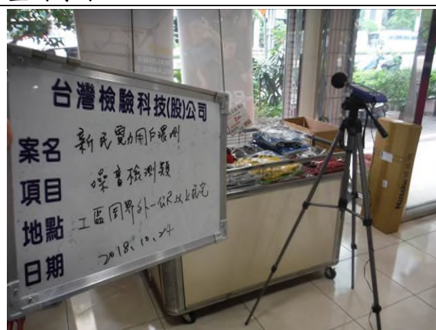
監測項目：低頻噪音 監測地點：工區周界外一公尺以上民宅 監測時間：2018.10.23
