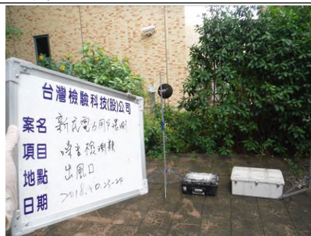
監測項目：噪音 監測地點：出風口 監測時間：2018.10.23
