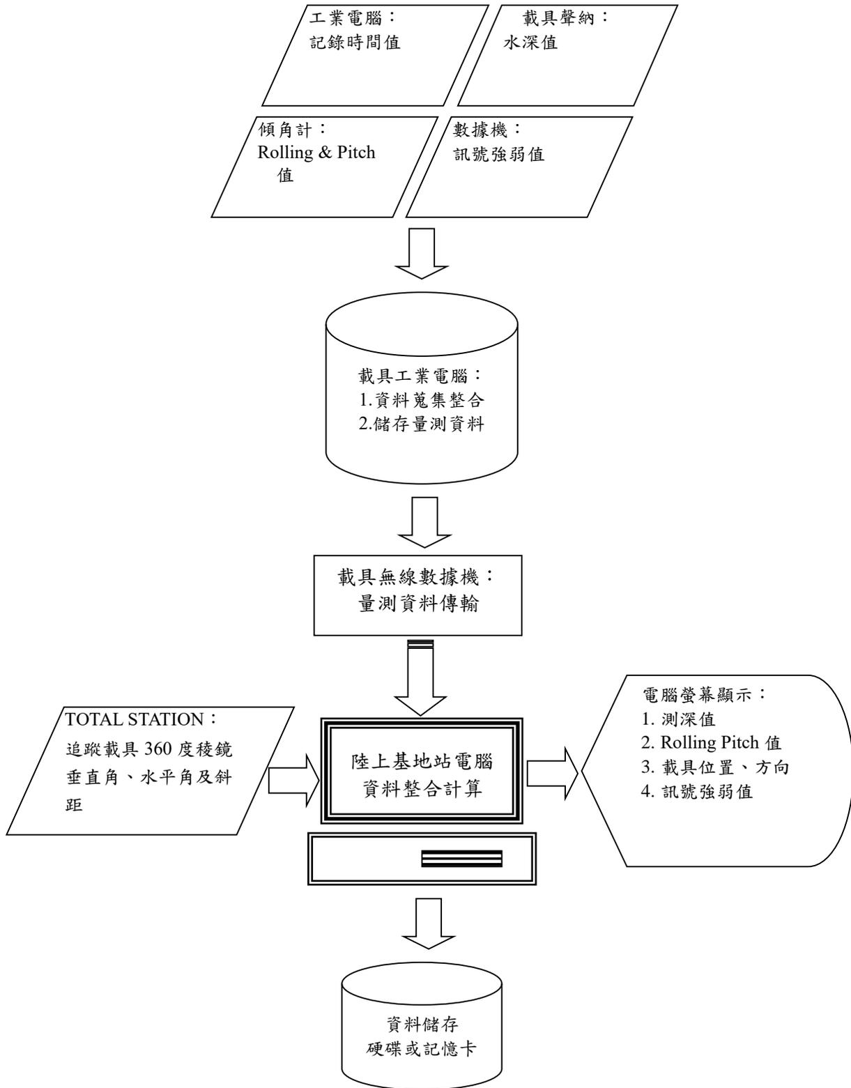
圖 3-5 量測系統資料處理流程圖
