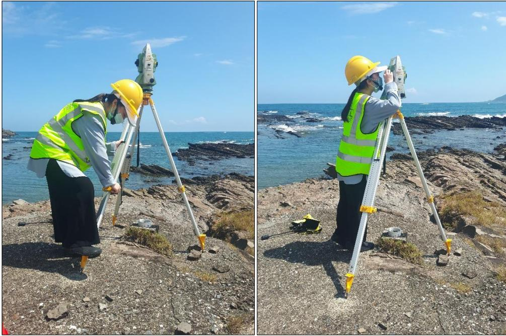
圖 3-2 全站式經緯儀架設於控制點
