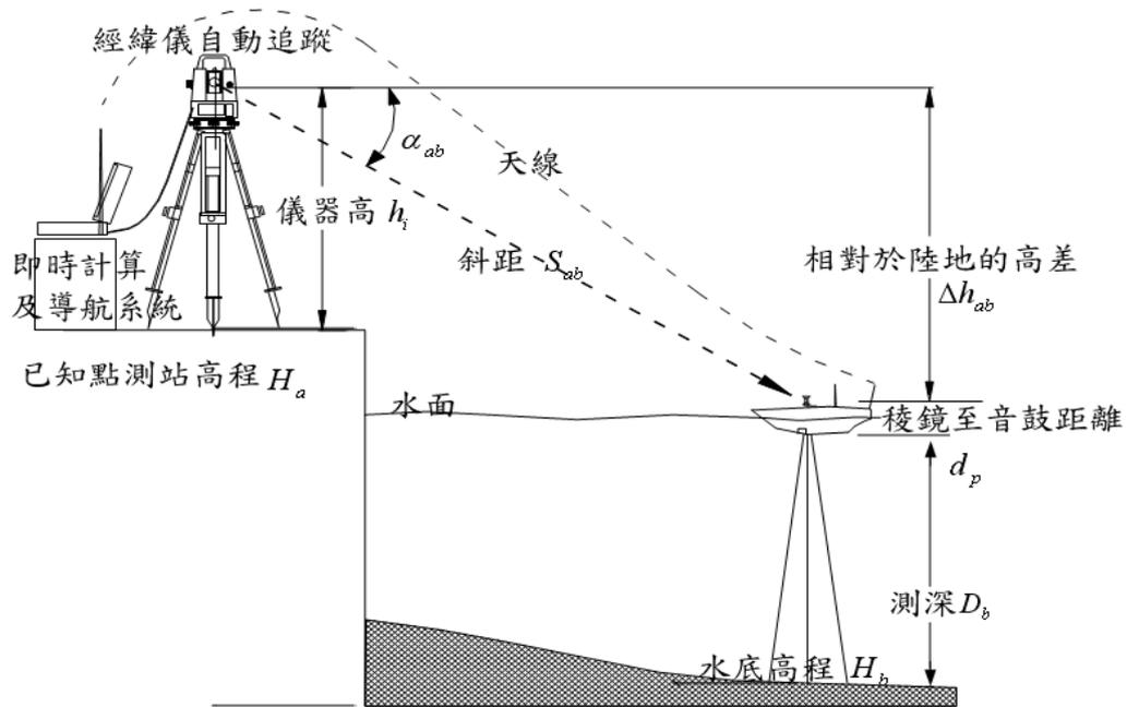
圖 3-6 測量載具作業佈置示意圖
