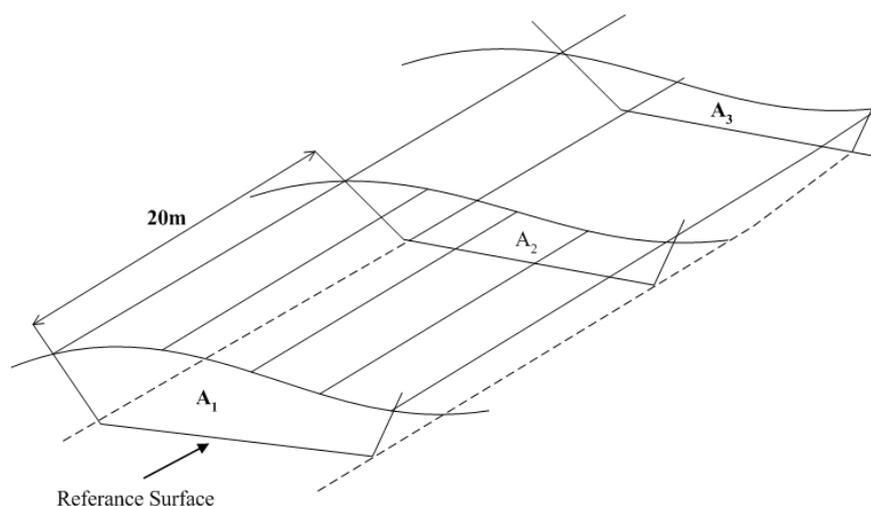
圖 3-4 土方計算原理示意圖
