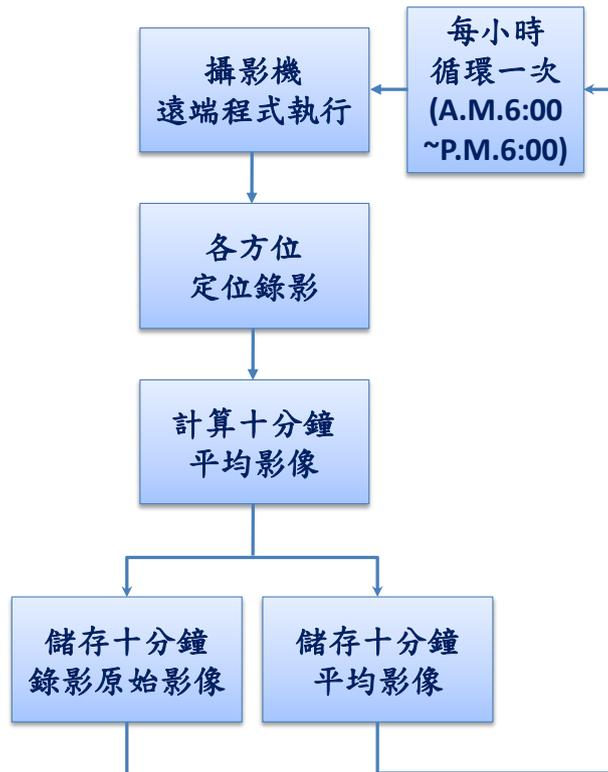
圖 3-19 影像觀測系統程式執行流程圖
