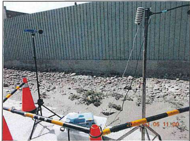
低頻噪音：電氣室旁(112.03.06)
