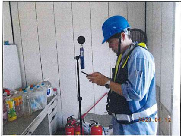
低頻噪音：電氣室旁(112.04.12)
