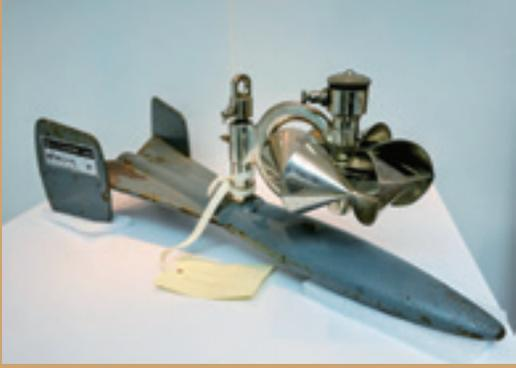
外型如飛機的「旋杯式流速儀」，是台電人 1960 年代用於水文調查的測量儀器，紀錄台灣最早以水力發電為主的綠能時代。
