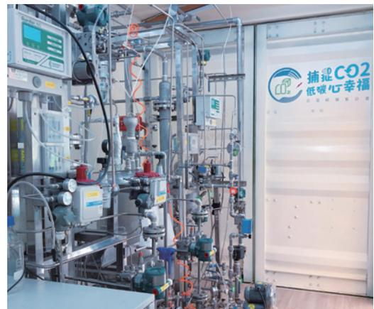
將二氧化碳透過吸附方式後，再由鋼瓶儲存的碳捕捉設備。
