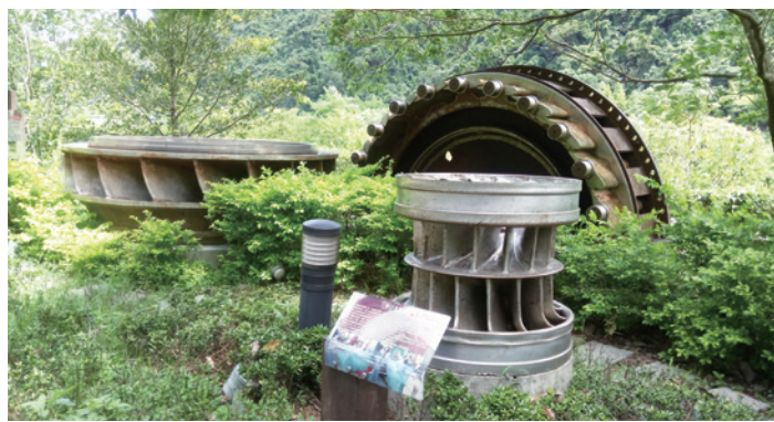
▲ 溪口及青山發電廠拆卸下來法蘭西斯式水輪機組。
