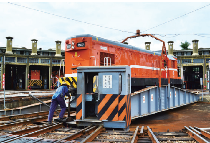
▲ 臺鐵工作人員先將機車固定在轉盤上。
