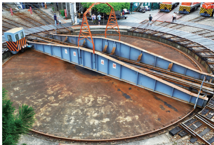
▲ 重達百噸的巨大火車機車就是靠著這個調車轉盤進出扇形車庫。
