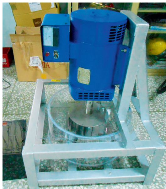
▲ 校園水力發電機組展示。
