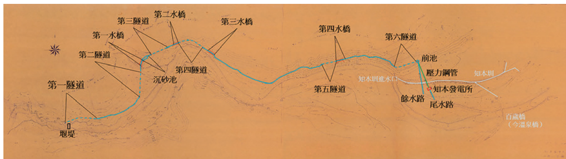
▲ 臺灣合同電氣株式會社繪製的知本發電所整體水路及電廠配置圖，再與今日的地圖對照即可清楚得知電廠預定地的現址就在知本圳沉砂池與勇男橋之間的高灘地。
