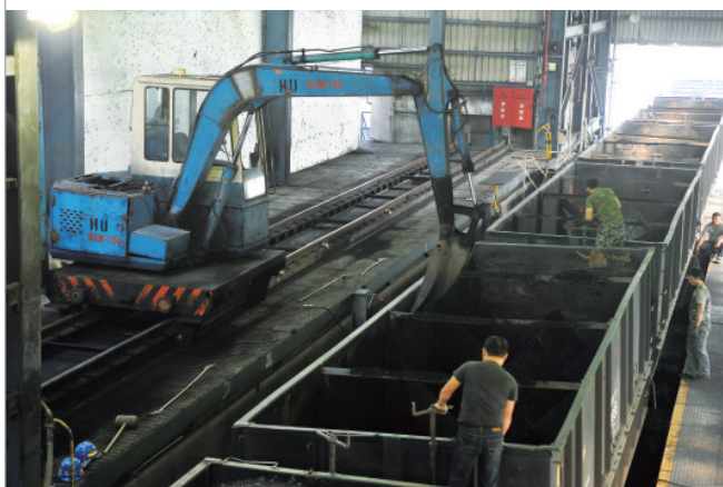
▲ 運煤火車卸煤作業。
