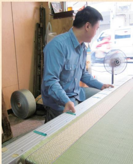
▲ 切割修整後，用壓尺確定平整度。
