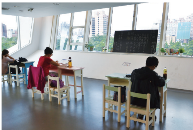
▲ 大片向內傾的窗既達到採光的效果，也迴避夏日的強光和日曬。
