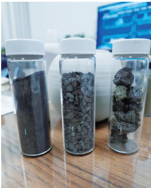
▲ 底灰是燃煤發電廠發電後的副產品。
