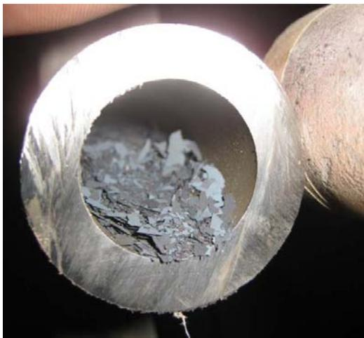
圖 7 爐管蒸汽側氧化
