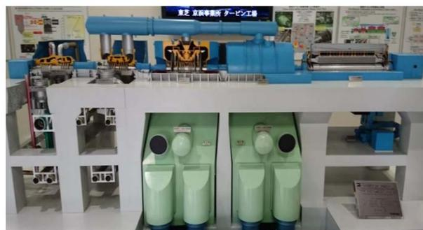
圖 20 串聯複合式四流(TC4F)四缸型式汽輪機模型
