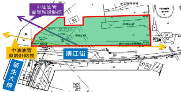
圖 22 中油油管設計及實際埋設路徑示意圖
