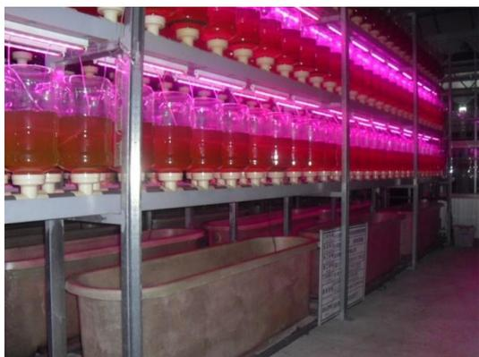
圖 22 微藻固碳系統
