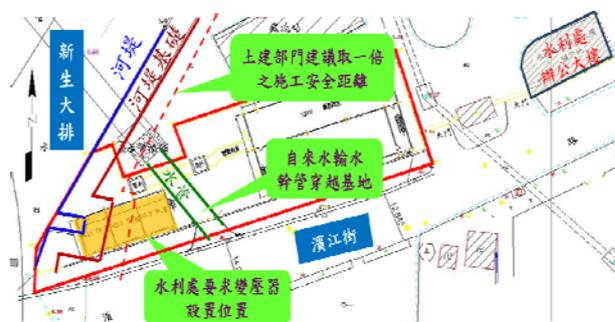
圖 20 自來水輸水幹管穿越基地及河堤與搭船台階基礎位置示意圖
