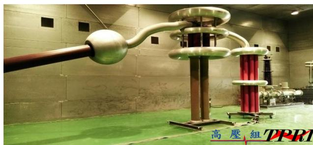
圖 3 高壓部分放電(Partial Discharge, PD)實驗室
